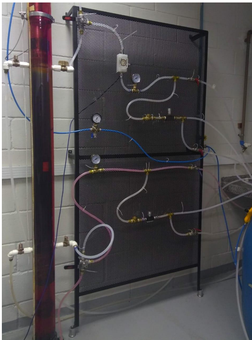
Figura 16. Experimento realizado onde após a estabilização do nível de água no tubo, com a operação simultânea das duas bombas hidráulicas, foi despejado um corante diretamente no tubo, de maneira a visualizar o trajeto percorrido pela água nesta situação.
